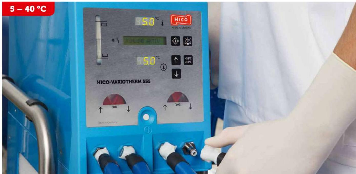
HICO-VARIOTHERM 555 – это изделие для контроля температуры с широким спектром применения, которое ценится за способность безотказно проводить обогрев и охлаждение пациентов в палатах интенсивной терапии и операционных. Изделие позволяет установить температуру воды в диапазоне 5 — 40 °С, что покрывает потребности всех областей применения.
